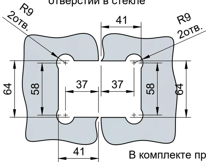
В комплекте прокладки для стекла 8 мм, 10 мм, 12 мм
