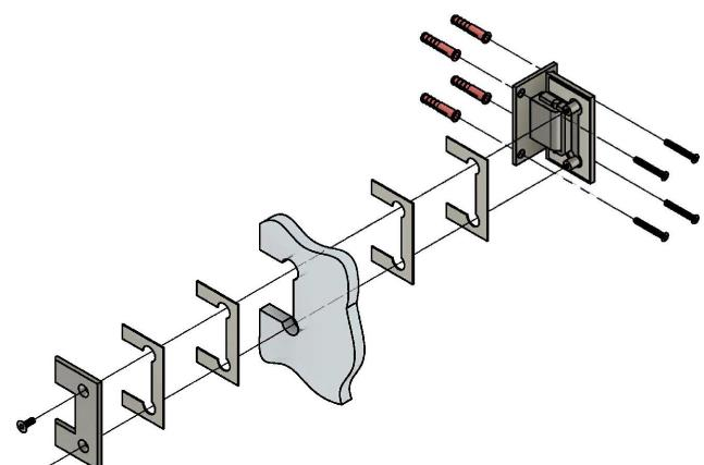
В комплекте прокладки для стекла 8 мм, 10 мм, 12 мм
