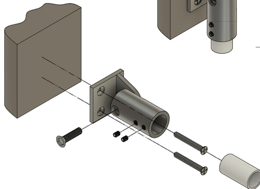
Подходит к трубе Ø18 мм, Ø19 мм
